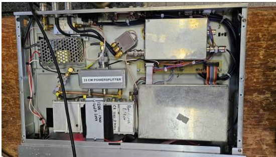
De 23 cm WFM ontvanger, met rechts onder het nog gesloten ontvanger blik.
